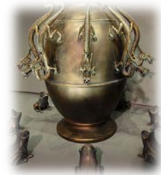
Ilustración 4. Reproducción del sismógrafo de ZhangHeng 1
